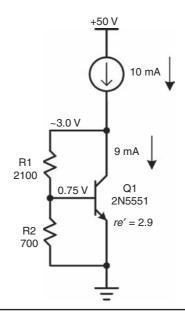
**FIGURE 2.11**  $V_{\rm be}$  multiplier.
