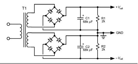
FIGURE 16.2 An alternative rectifier arrangement.
